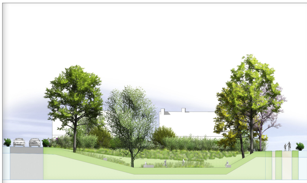
Profil du bassin de rétention et d'infiltration des eaux pluviales - Hypothèse 2 : Pente 1/3
